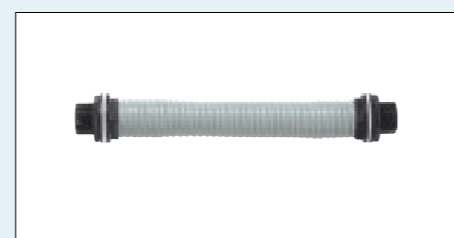
Set de jumelage pour relier deux cuves. Livré avec 2 embouts filetés, 2 joints, 2 écrous et 23 cm de tuyau transparent.
