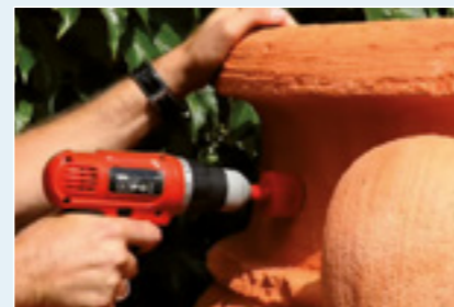
Perçage de la cuve à l'aide d'une scie cloche.
